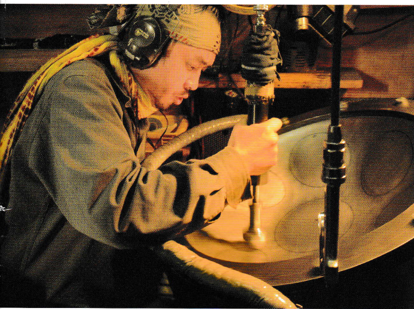
エアハンマーで鉄板を叩く
